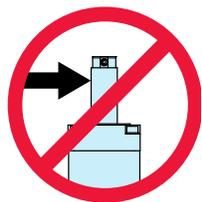
Una carga lateral excesiva en la varilla de empuje de salida del actuador reducirá drásticamente la vida útil del actuador y debe evitarse. La carga lateral puede ser causada por la desalineación o la carga que no está en línea con la varilla de empuje de salida del actuador.
